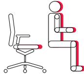
Regula la separación entre el respaldo y el borde delantero del asiento, creando una superficie de apoyo óptimo para los muslos, también en el caso de los usuarios de mayor talla. Con el ajuste Astiv, el punto de apoyo de la espalda se mantiene invariable.
