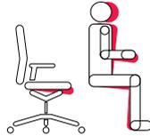
El ajuste en varias etapas de la superficie del asiento actúa contra la inclinación de la pelvis hacia atrás, lo que reduce tensiones en la columna vertebral y el arqueado de la espalda.
