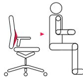
El apoyo lumbar de ajuste horizontal se puede adaptar a la convexidad individual de las vértebras lumbares; se reduce el esfuerzo muscular.
