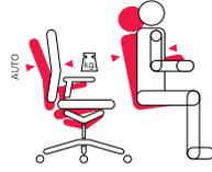
El ajuste de la contrapresión del respaldo se realiza automáticamente según el peso y el tamaño de cada usuario y dispone además de un ajuste fino.
